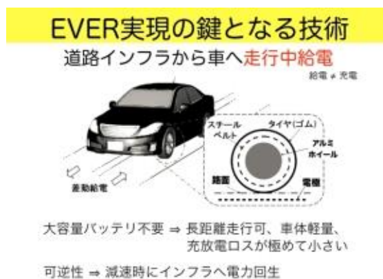
図 5. 走行中給電システム
