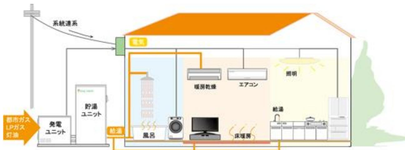
図8. 燃料電池を使用したコージェネレーションシステム
